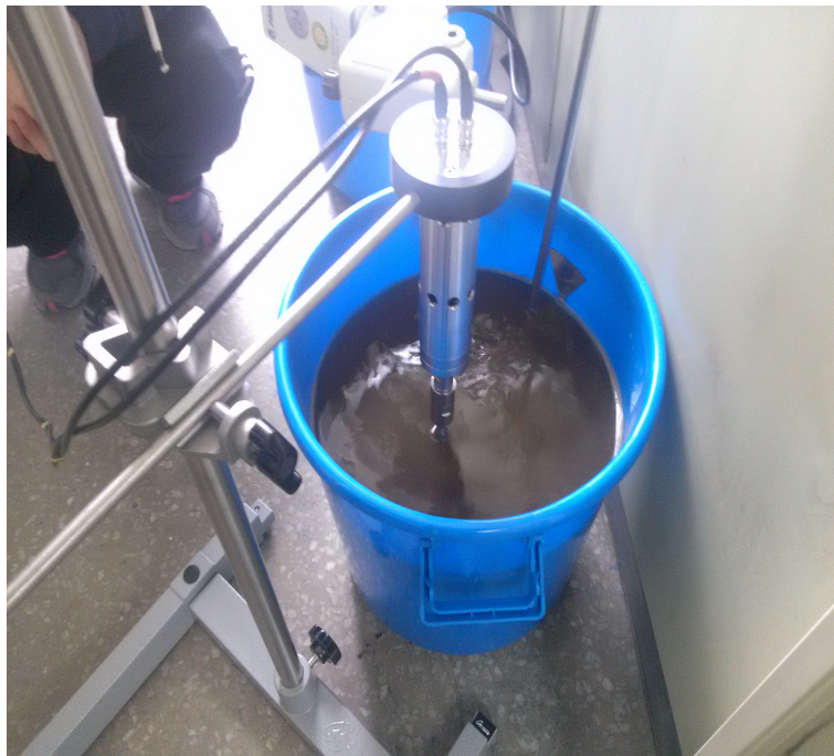
그림 3.3 회분식 호기성 소화 실험 장치
