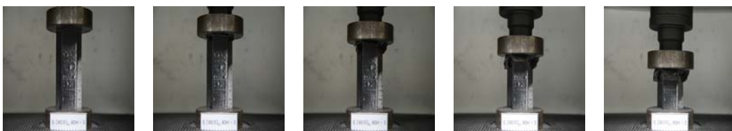
(a) \delta = 0\text{mm} (b) \delta = 10\text{mm} (c) \delta = 20\text{mm} (d) \delta = 40\text{mm} (e) \delta = 60\text{mm}
