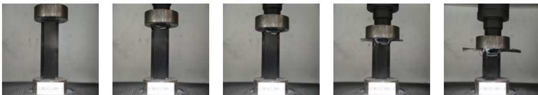
(a) \delta = 0\text{mm} (b) \delta = 10\text{mm} (c) \delta = 20\text{mm} (d) \delta = 40\text{mm} (e) \delta = 60\text{mm}
