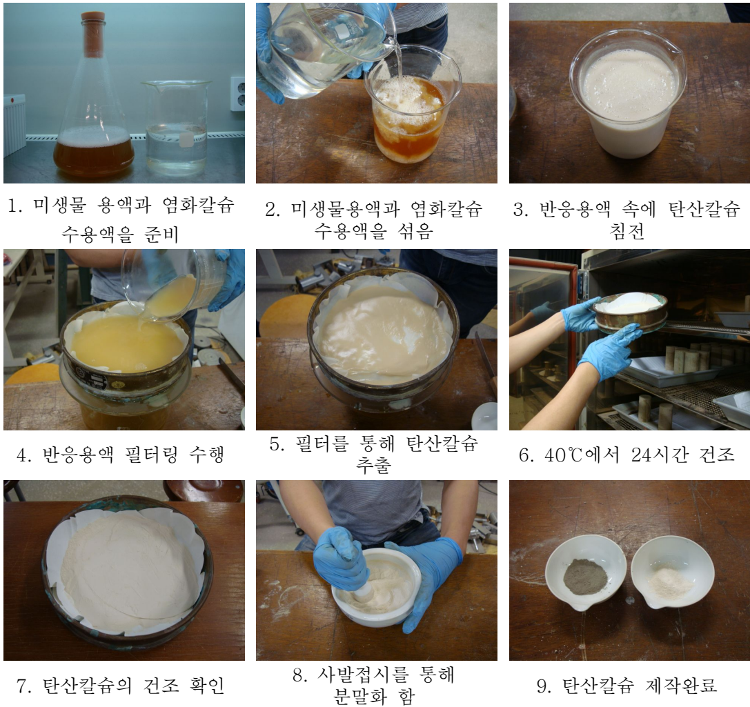
그림 3.4 탄산칼슘 추출 및 제작
