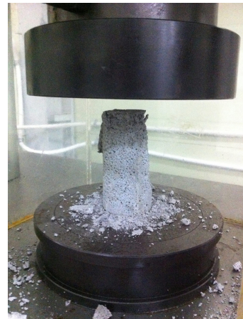
그림 3.51 일반형저점도 일축압축강도 측정 결과 및 파괴양상
