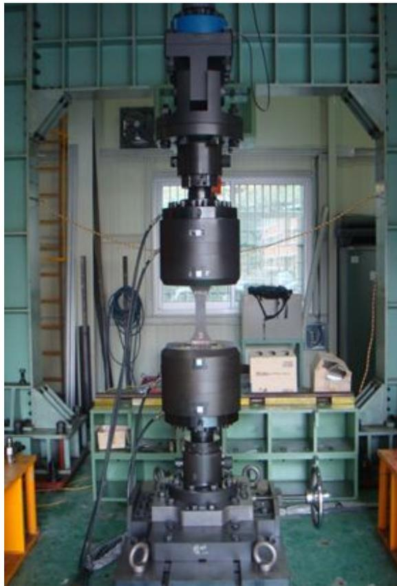
Fig.22 피로시험 모습
