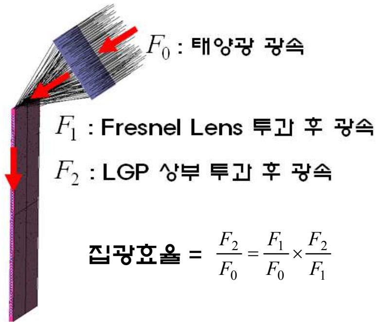
그림 4.6 선형 프레넬 렌즈를 이용한 집광 구조와 도광판의 모습.
