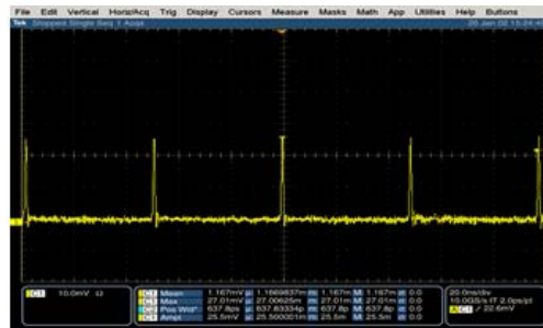
그림 32. 오실로스코프로 측정된 렌즈 초점길이에 따른 펄스열 (a) 렌즈 50 mm일 경우 펄스열, (b) 렌즈 75 mm일 경우 펄스열
