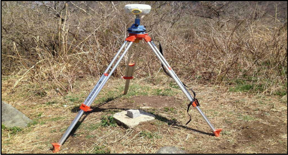
그림 3.7 삼각점 광주435 정지측량 모습
