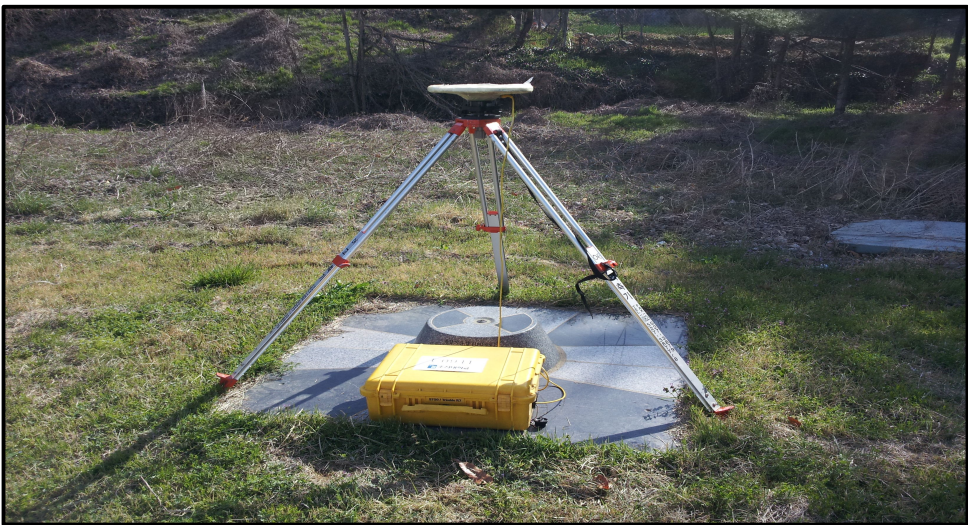
그림 3.8 통합기준점 U0941 정지측량 모습
