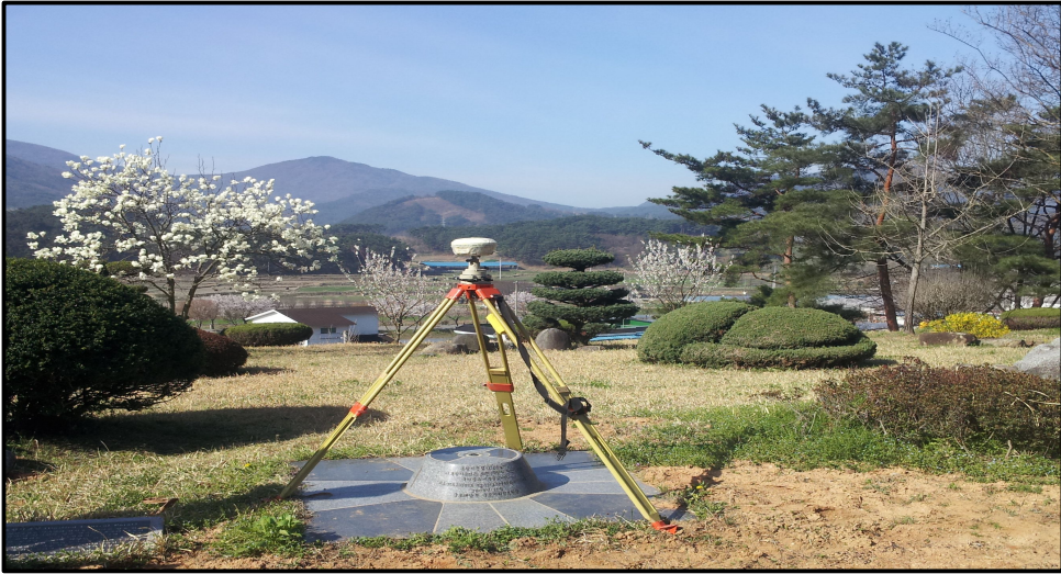
그림 3.9 통합기준점 U0947 정지측량 모습
