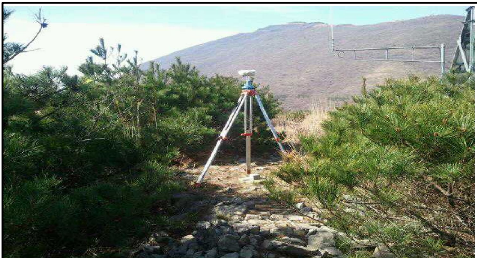
그림 3.4 삼각점 독산451 정지측량 모습
