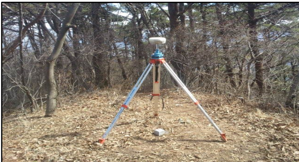
그림 3.6 삼각점 광주434 정지측량 모습
