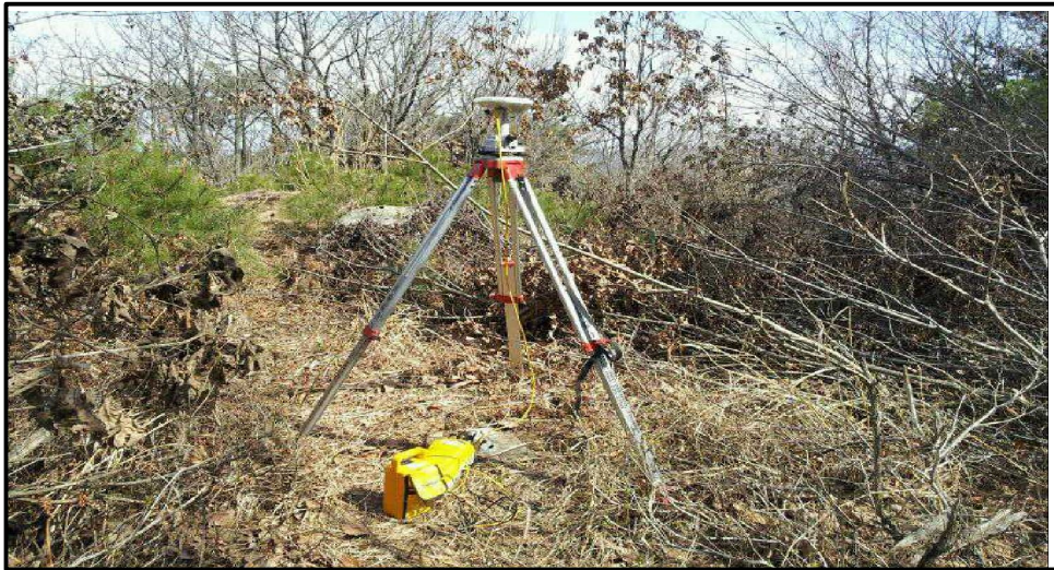
그림 3.5 삼각점 독산453 정지측량 모습
