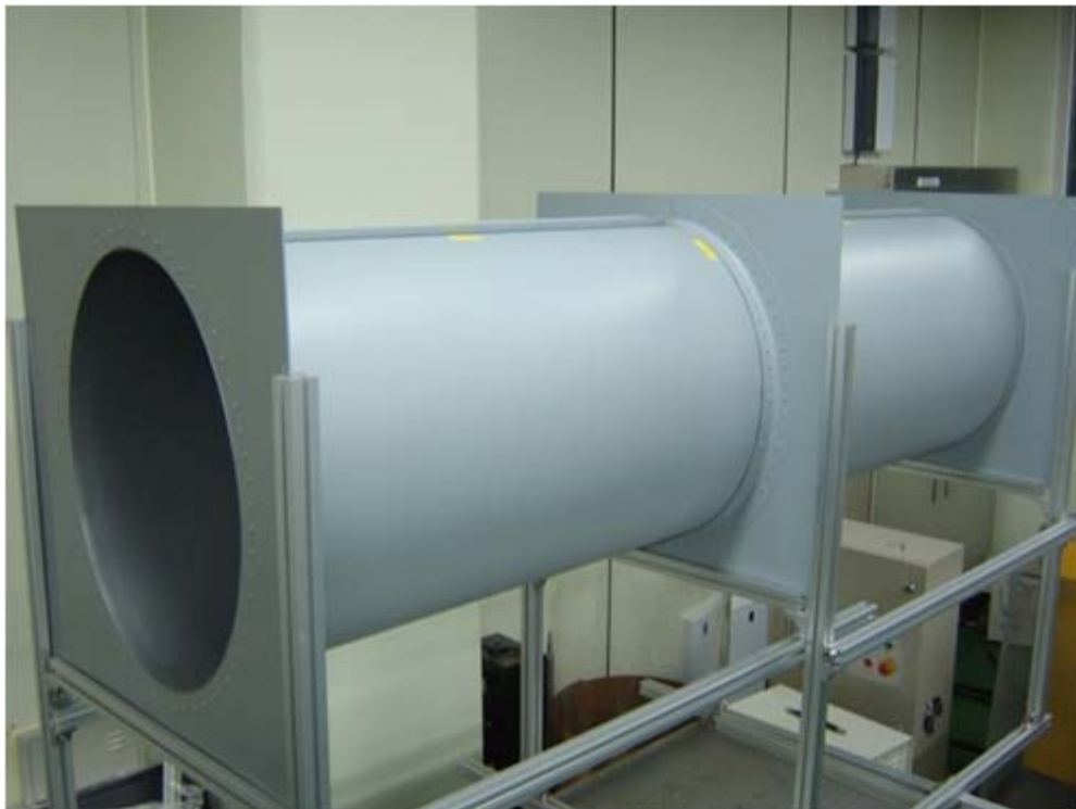
Fig. 4-13 조립 완료한 인테이크 모형 시험편
