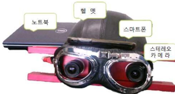
Fig 2.1. 자기위치 파악 시스템 프로토타입
