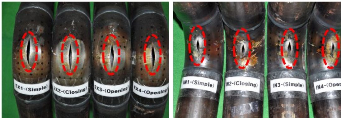
그림 3.1.2 하중제어 곁힘하중의 손상시험 결과 시편 손상모드
