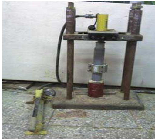
그림 1.1 PVC Mold 공시체 성형장비(오종신, 2008)
