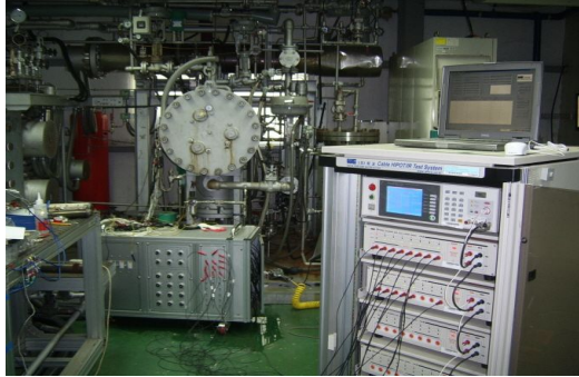
그림 4.2.9 DBE 환경 모의시험 중 절연 저항 시험
