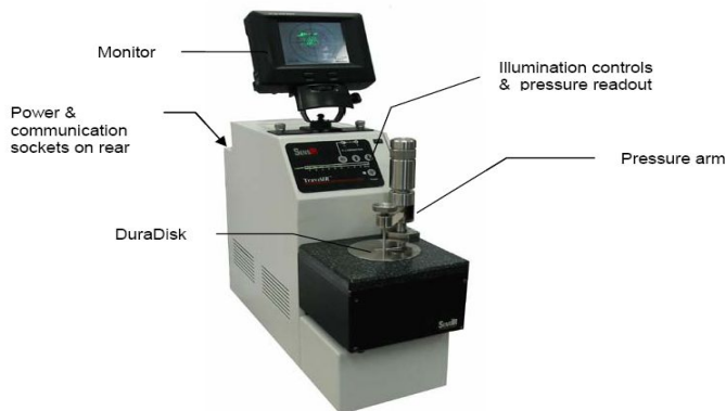
그림 3.2.1 Smiths사의 Travel IR 장비
