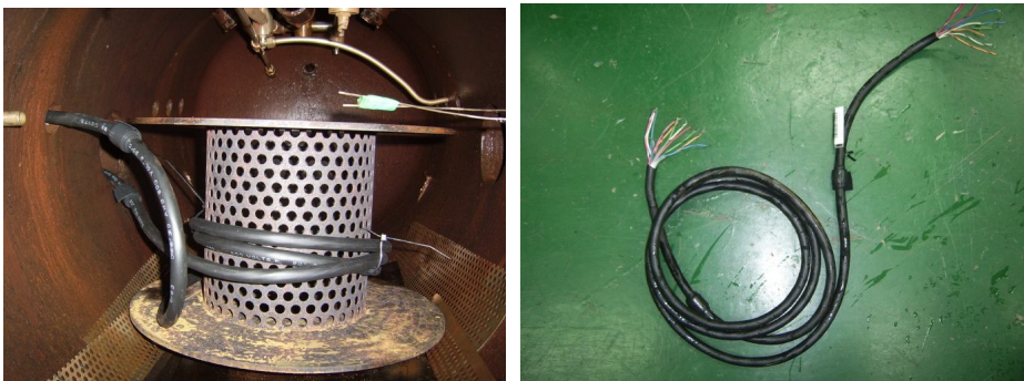
그림 4.2.12 DBE 환경 모의시험 완료 후 시편
