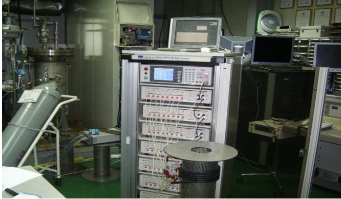
그림 4.2.2 열적 가속 노화 전 절연저항 측정
