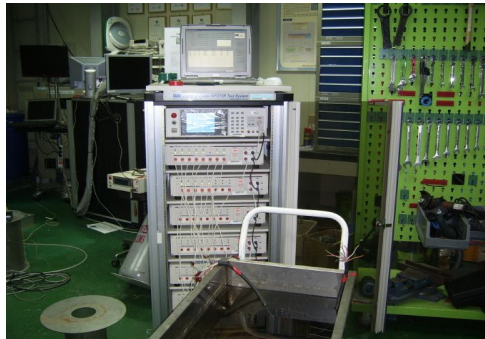
그림 4.2.11 DBE 환경 모의시험 후 침수 내전압 시험
