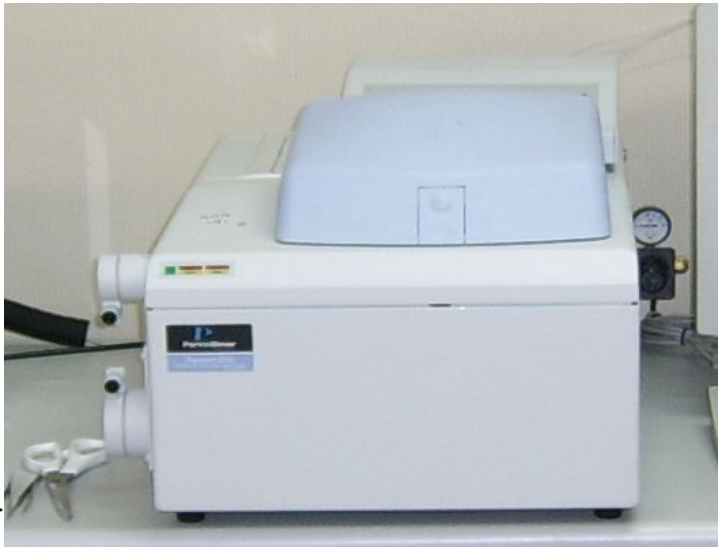
그림 3.2.4 Perkin Elmer사 Diamond DSC
