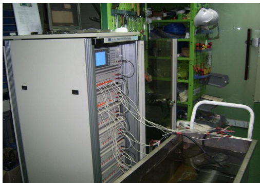
그림 4.2.7 방사선 조사 후 침수 내전압 시험
