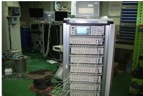
그림 4.2.10 DBE 환경 모의시험 후 절연저항 시험
