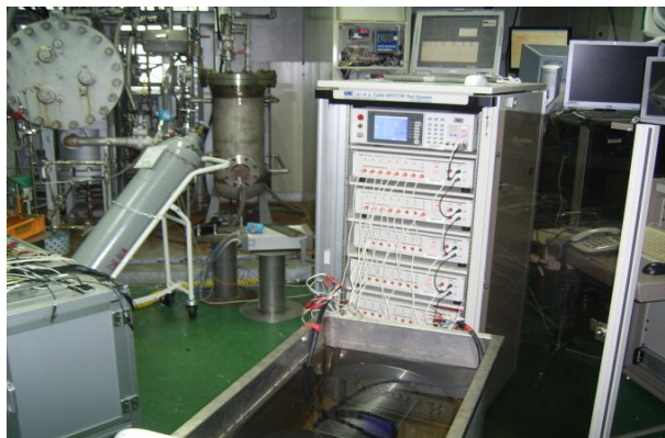
그림 4.2.3 열적 가속 노화 전 침수 내전압 측정
