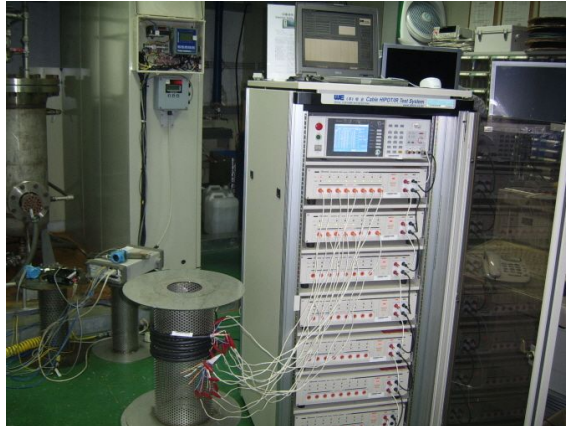
그림 4.2.5 열적 가속 노화 시험 후 절연저항 측정
