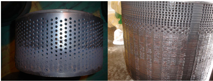
그림 2.5 영광 6호기 DFCV 및 EFCV Cage 막힘사진
