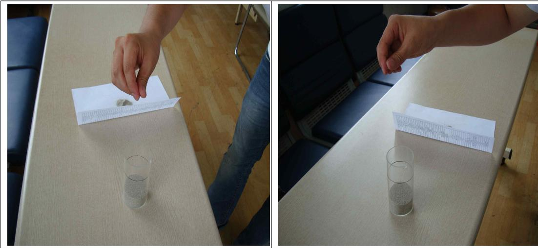
그림 3.12 모래 시료  $r_{d(\min)}$  산정 방법
