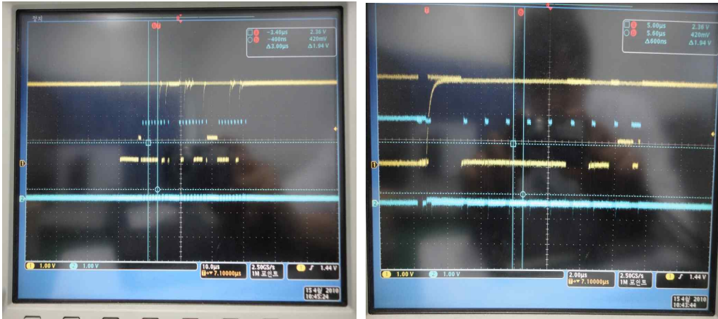
그림 67. USN 환경센서 센서 샘플링 신호
