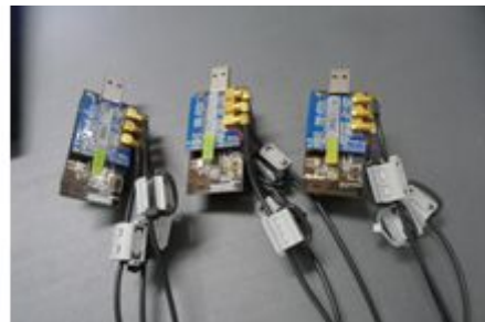
(그림 3) 유도전극을 이용한 심전도 센서보드와 무선 센서노드
