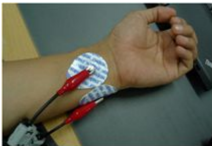
(그림 3) 유도전극을 이용한 심전도 센서보드와 무선 센서노드
