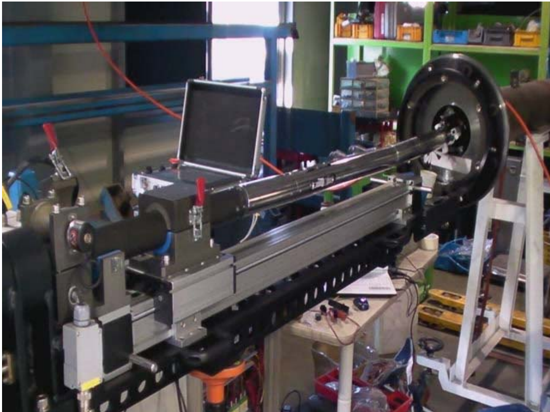
Fig. 3-8 로터 중심공 스캔용 로봇
