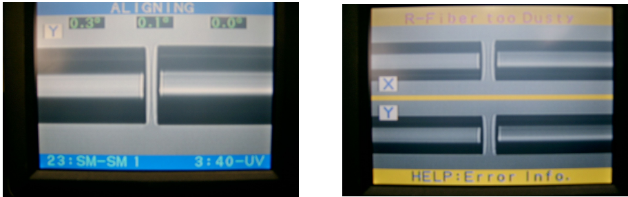
그림 3.24 코어 정렬 접속 조건으로 용착 접속, (a) 용착 접속 전의 광섬유 (b) 용착 접속 오류 발생
