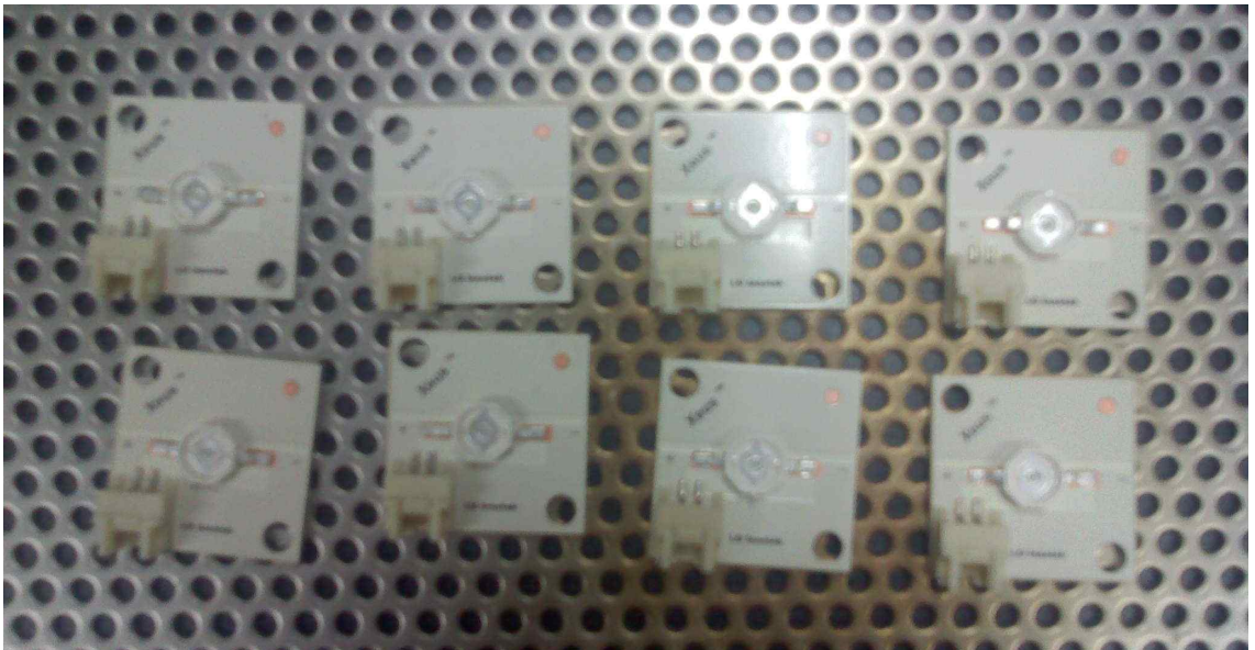
[그림. 18] PCB 접합을 한 LED 패키지 사진
