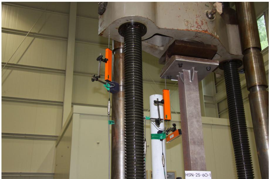
[사진 3] 실험체의 변위 측정 전경
