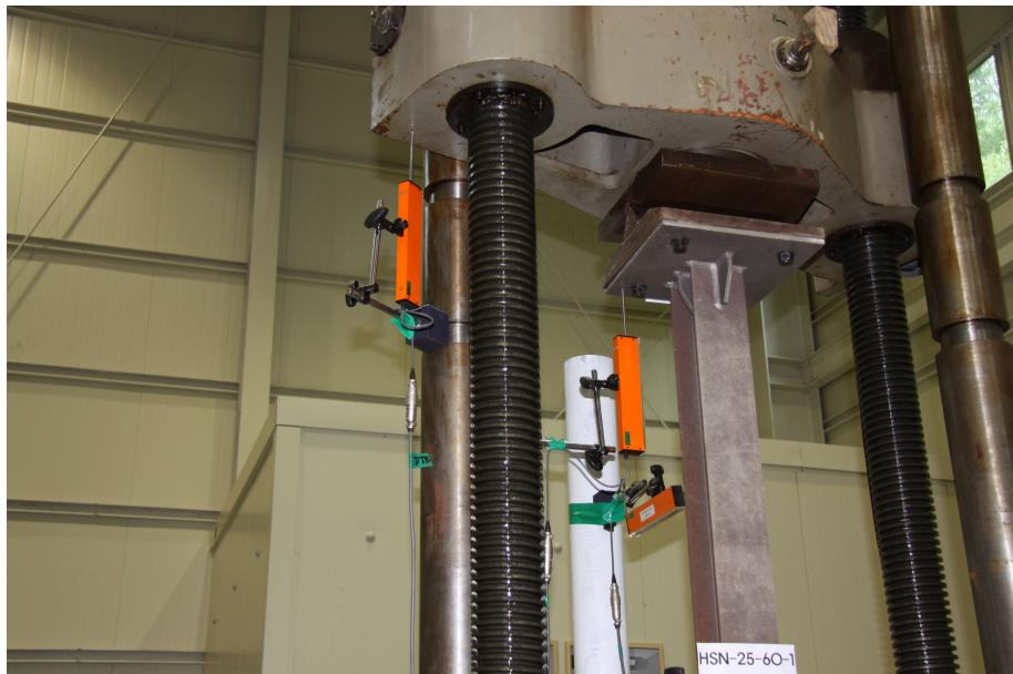
[사진 3.4] 기준 실험체의 변위 측정 전경
