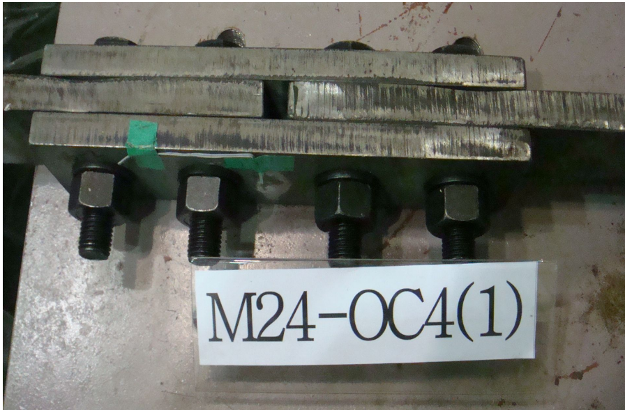
그림 3.30 M24_OC4_1 시험편 인장실험 후 모습
