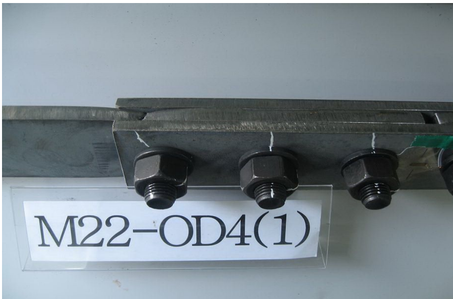
그림 3.16 M22_OD4_1 시험편 인장실험 후 파괴모습
