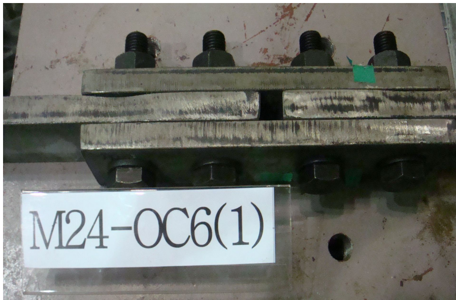
그림 3.32 M24_OC6_1 시험편 인장실험 후 모습
