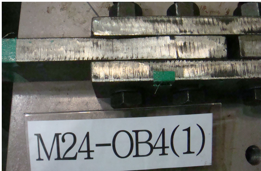
그림 3.26 M24_OB4_1 시험편 인장실험 후 모습
