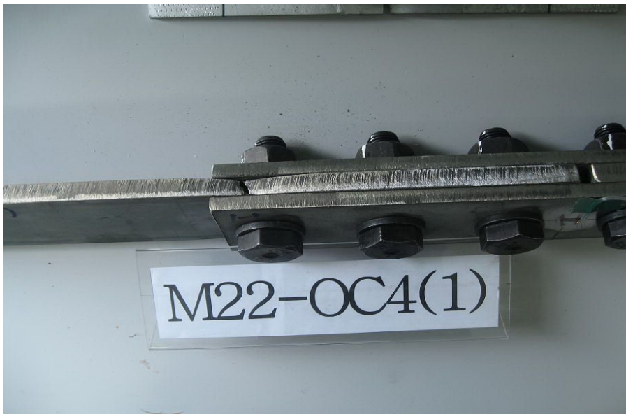
그림 3.12 M22_OC4_1 시험편 인장실험 후 파괴모습
