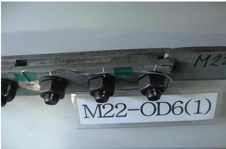
그림 3.18 M22_OD6_1 시험편 인장실험 후 파괴모습
