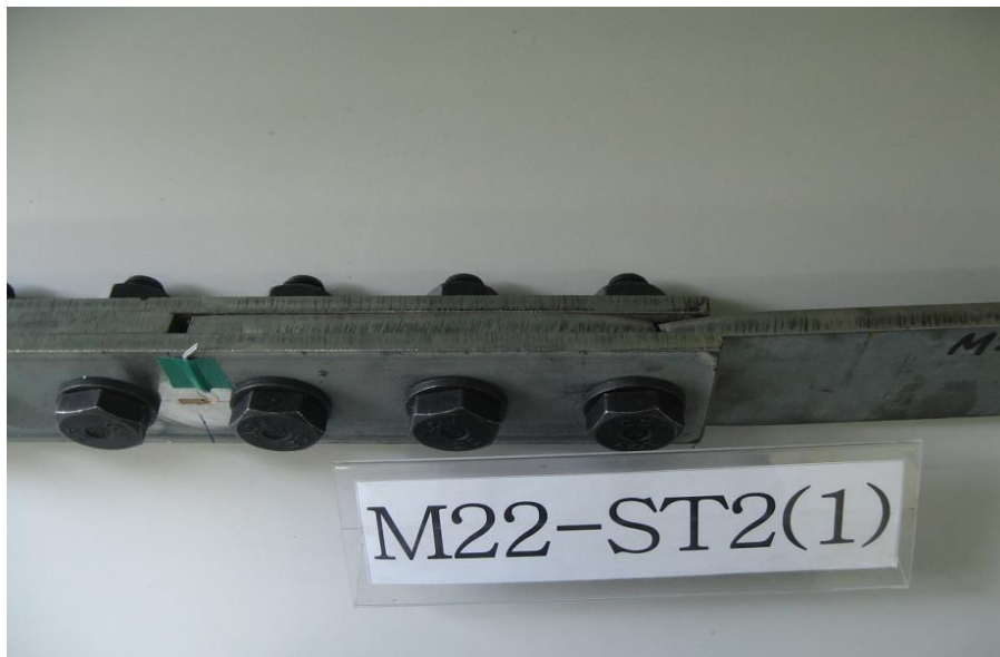
그림 3.6 M22-ST2_1 시험편 인장실험 후 파괴모습
