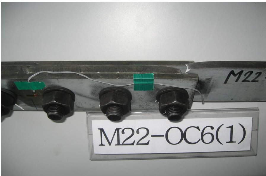
그림 3.14 M22_OC6_1 시험편 인장실험 후 파괴모습
