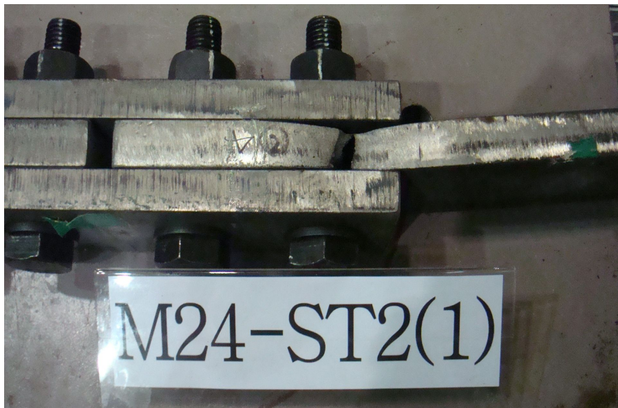
그림 3.24 M24_ST2_1 시험편 인장실험 후 파괴모습
