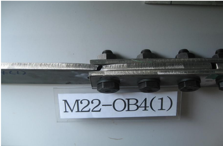
그림 3.8 M22_OB4_1 시험편 인장실험 후 파괴모습
