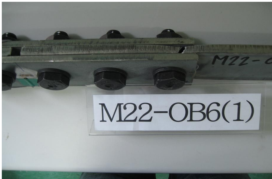
그림 3.10 M22_OB6_1 시험편 인장실험 후 파괴모습
