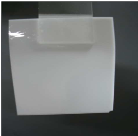
Scheme 5. 제작된 고분자 겔 전해질 (5 cm × 8 cm)
