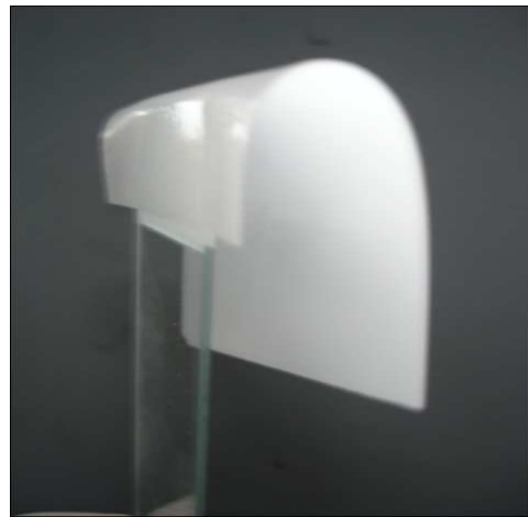
Scheme 5. 제작된 고분자 겔 전해질 (5 cm × 8 cm)
