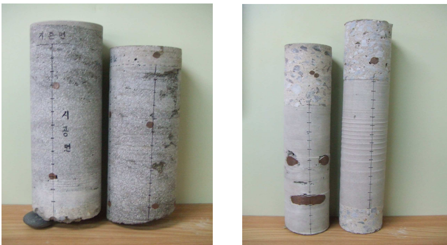
사진 4.4 Mock-up Test의 건식·습식 Jet스프레이공법에 의해 제작된 시편
