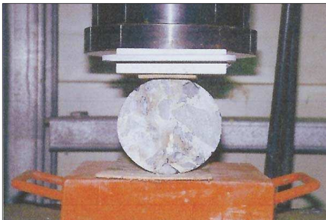
사진 B-6 콘크리트 구체의 할렬 인장강도실험
