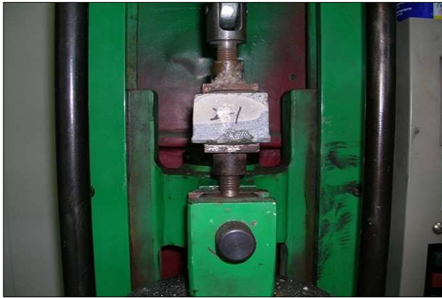
사진 B-5 보강 구조물의 부착강도실험
