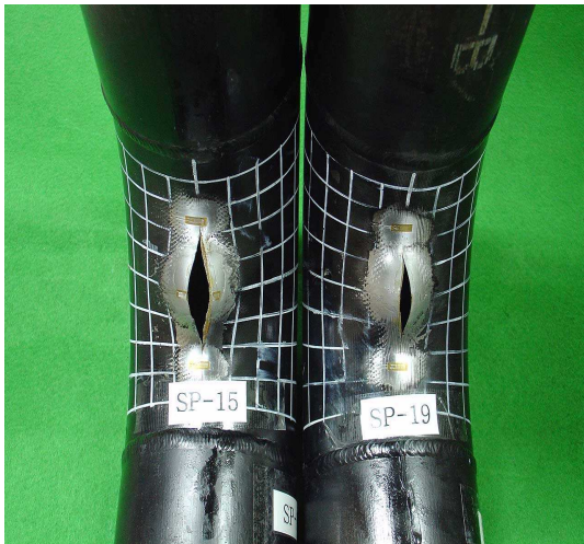
a) 외호면 결함(Extrados defect)
