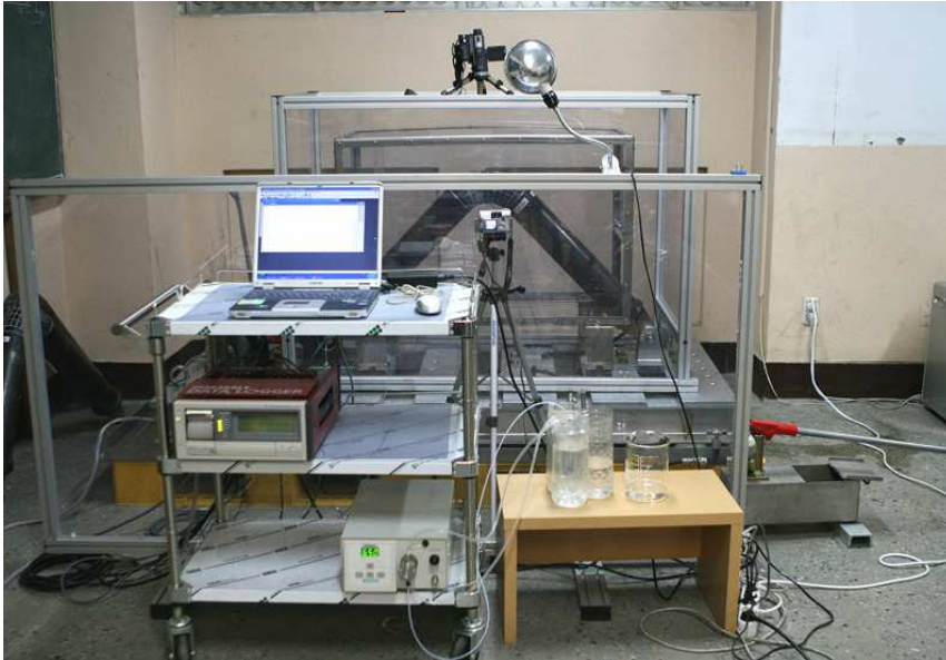
그림 2.3.4 실 배관 손상시험 장면
