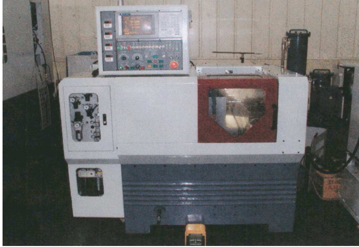
Photo. 3.1 Ultra-precision turning center
