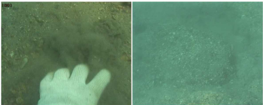
Fig. 2.23 Type 2 수중 본체에 의한 유기퇴적물 수거 전후 상태
