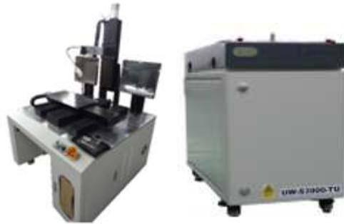
Fig. 3.1 Fiber laser machine(LMS社의 3축 Laser System)
