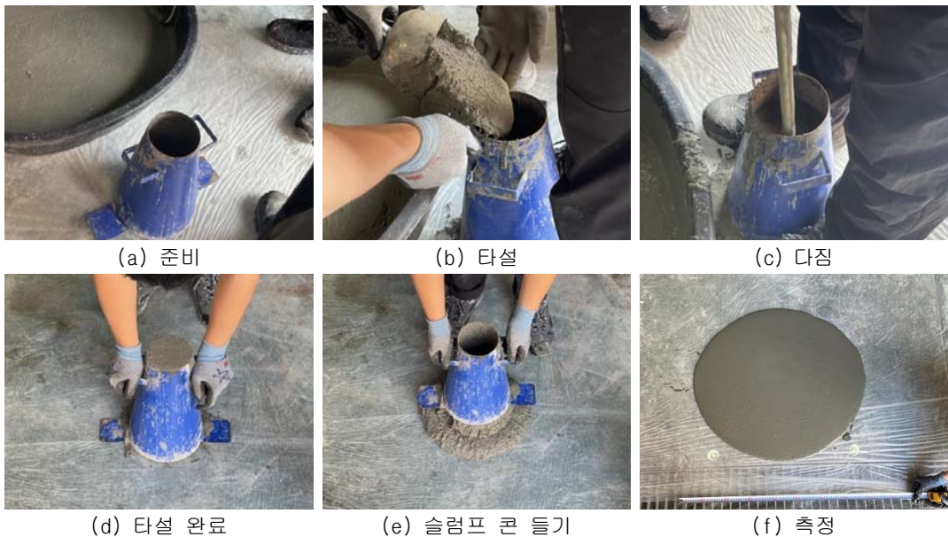
[그림 3.3] 슬럼프 플로 시험
