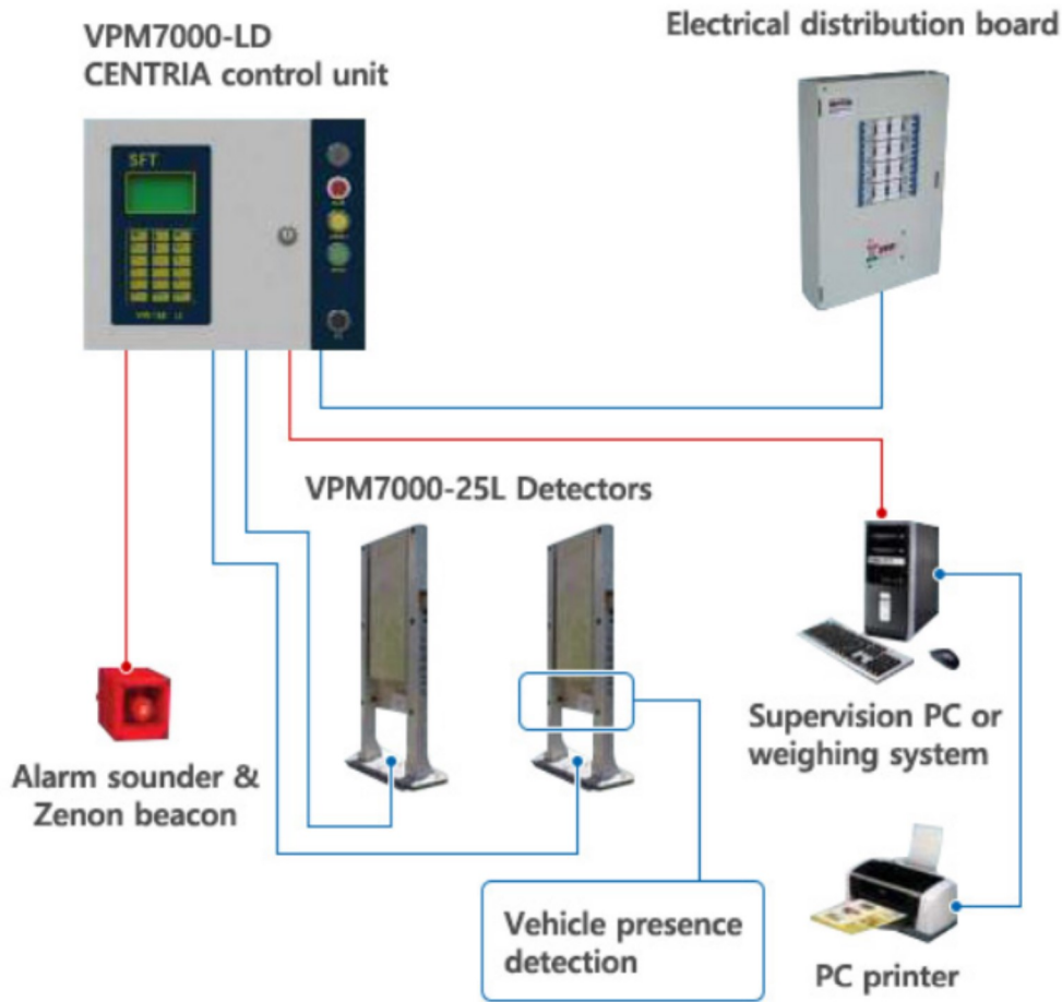
그림 23. 플라스틱신틸레이터를 이용한 차량오염감시시스템
