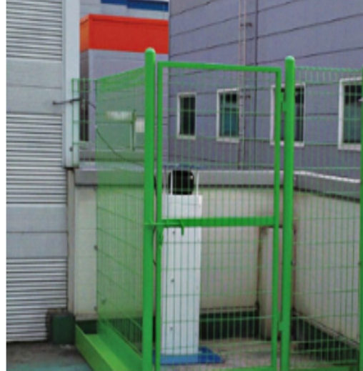
그림 24. NaI Scintillaor 를 이용한 고정형 환경 방사선 감시시스템
