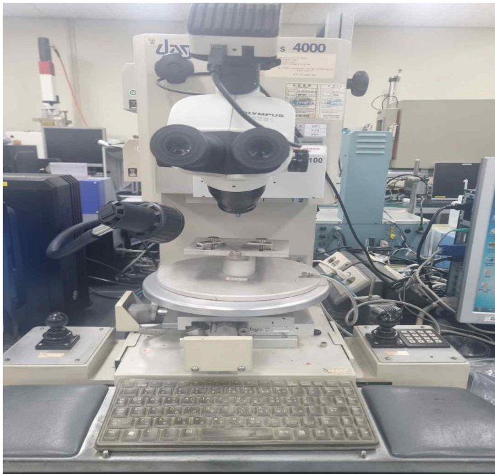
Fig. 3.7 Die shear tester : Dage, BT 4000
