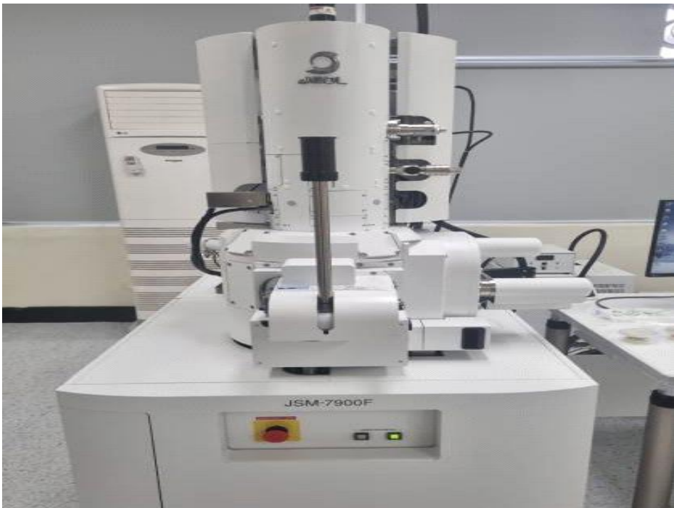
Fig. 3.6 Normal SEM : JSM7900F/JEOL
