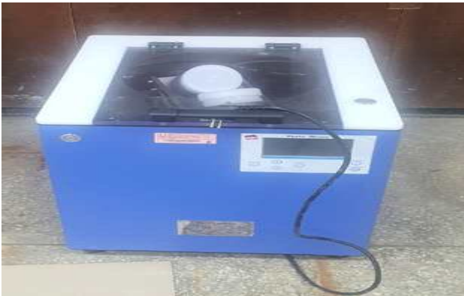
Fig. 3.3 페이스트 믹서(Paste Mixer, 대화테크, PDM-300)
