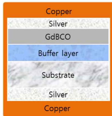
Fig. 4-3. 초전도 한류 모듈에 사용된 초전도 선재 내부 구조도
