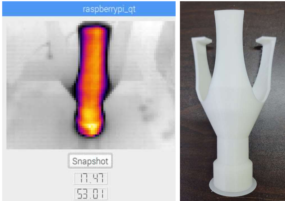
[그림 19. FDM방식 출력물의 열 가공 처리 실시간 이미지]
