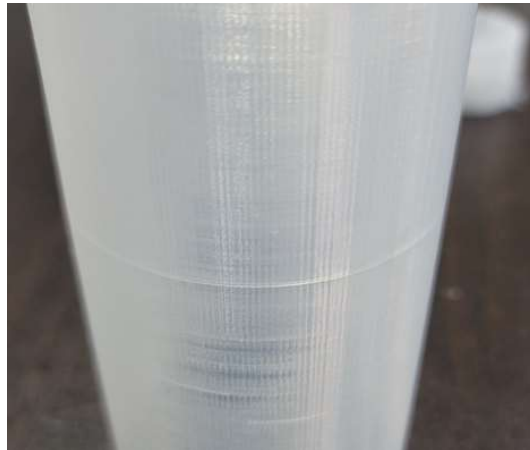
[그림 5] FDM출력방식 결과물의 표면 층간 갈라짐
