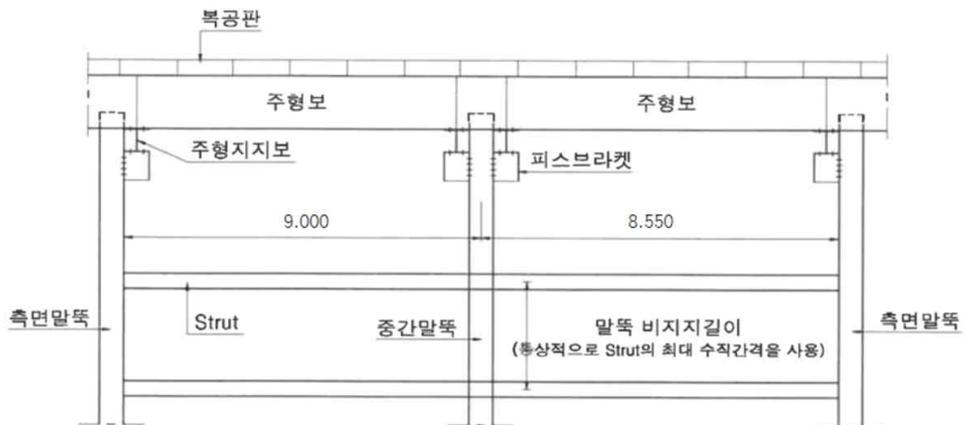
그림 4.2 중간말뚝 설치 세부조건
