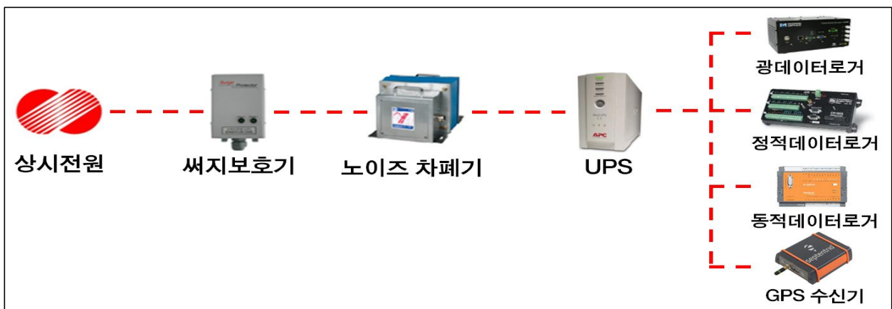
그림3.3 계측시스템 무정전 전원공급 장치 구성도
