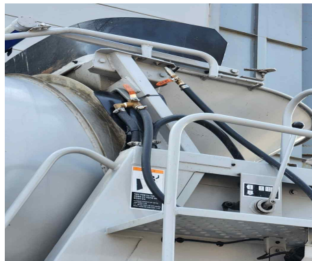
[그림 2.3] 에지테이터 트럭 상부로 이어지는 밸브
