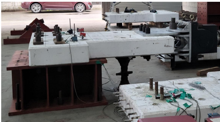
그림 3.1 프리캐스트 콘크리트 슬래브 연결부 실험체
