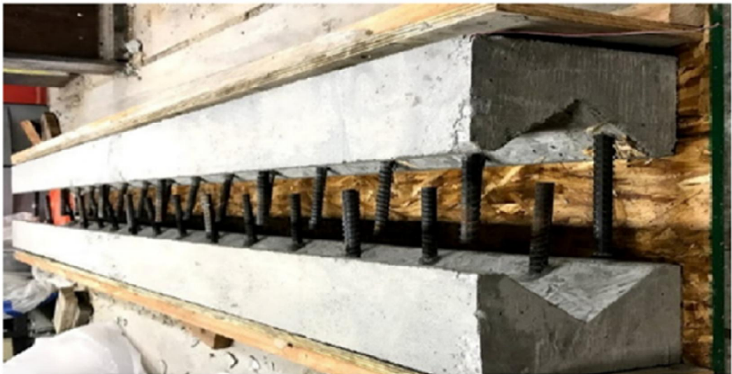
그림 2.3 추가 철근을 활용한 프리캐스트 콘크리트 연결부 (Nasrin and Ahmed., 2021)
