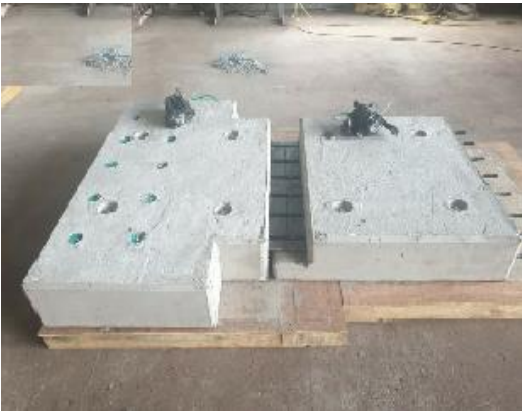
(e) 콘크리트 양생
