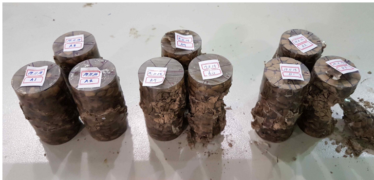
그림 36. 경화 온도 변화에 따른 펠렛 폴리머 고화체의 압축강도 측정 후의 모습
