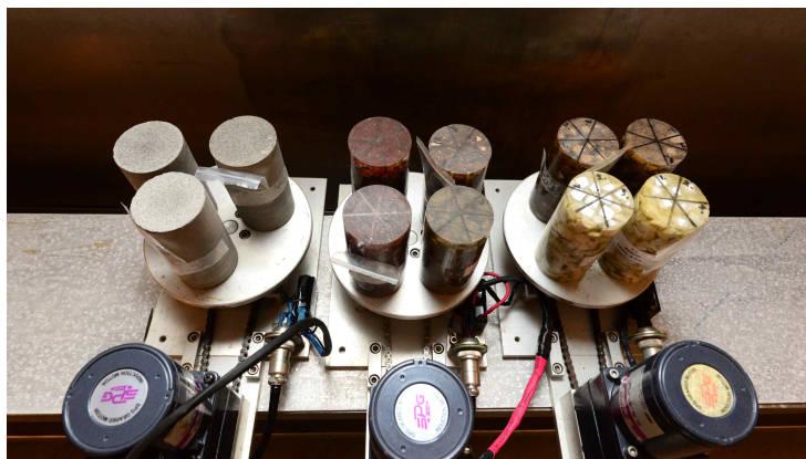
그림 43. 제조된 폴리머 고화체의 방사선조사 시험 모습
