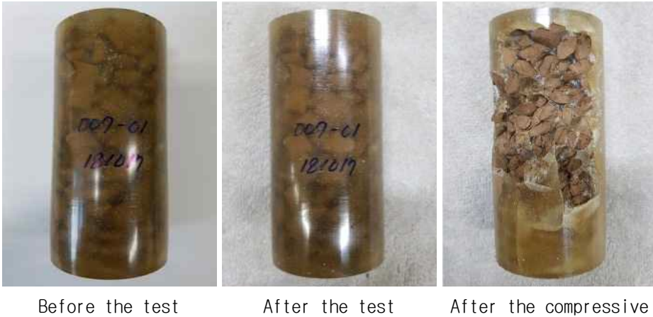
그림 51. Appearance of polymer solidified body(Thermal cycling test)
