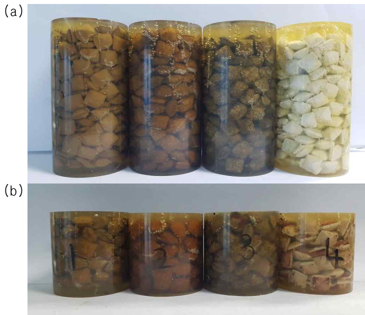
그림 42. 제조된 펠릿 폴리머 고화체 시험 시편 - (a) 특성평가용, (b) 침출시험용
