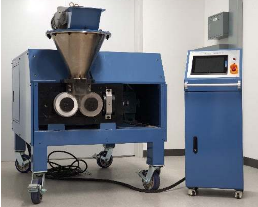
그림 13. 사용된 롤 컴팩터(roll compactor)의 실제 모습
