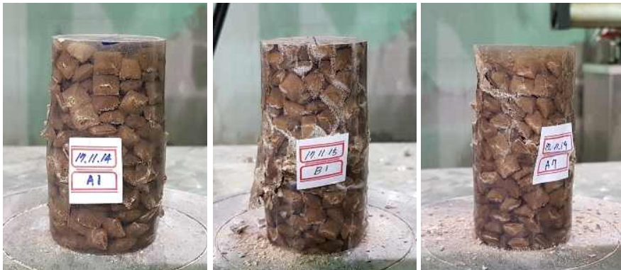
그림 49. Appearance of polymer solidified body(Compressive strength test)
