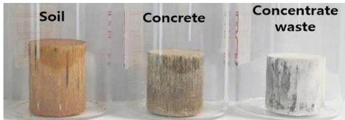
그림 17. 압축성 평가로 얻어진 원통형 분말체의 형상
