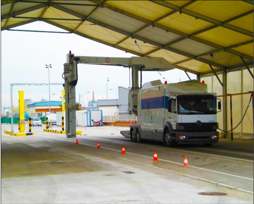
그림 4.3 컨테이너 안보 계획(CSI) 프로그램의 수입화물 방사선 이미지 장비
