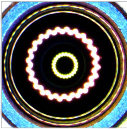
그림 17. LF2P01X 모델 상측 Laplacian filter 정상 이미지
