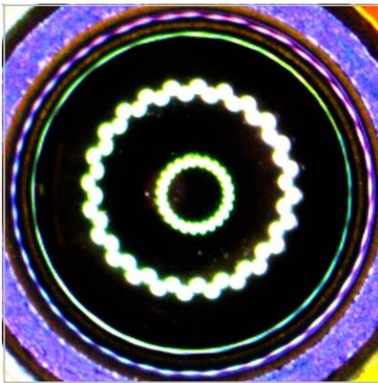
그림 18. LF2P01X 모델 상측 Laplacian filter 비정상 이미지
