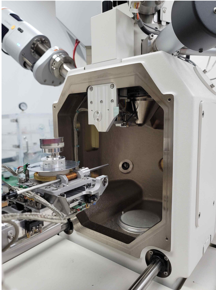
그림 3.7 SEM-EDS에 장착 중인 마운팅 시편
