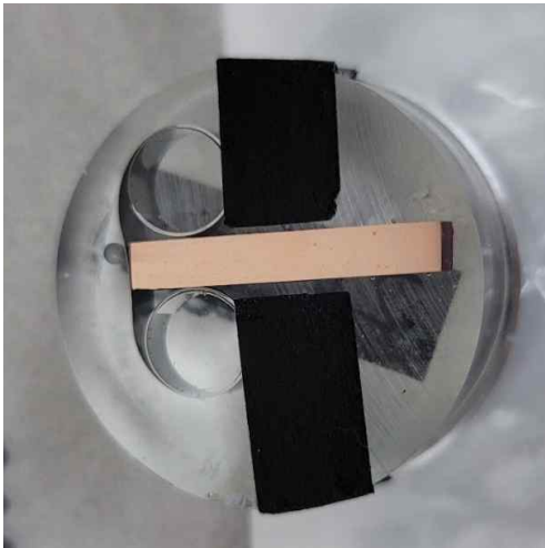
그림 3.6 절단 후 콜드 마운팅 진행한 Cu 시편 사진, Pt 코팅 진행 사진
