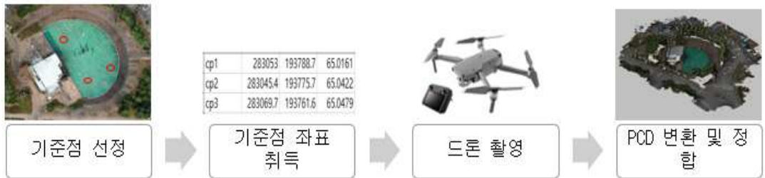
그림 2-2 드론을 활용한 건축물 PCD 수집 프로세스
