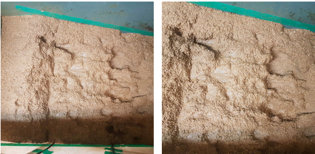
그림 3.11 강우재현 실험 사면파괴 결과
