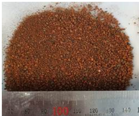
(a) 확장된 셰일(ES) (b) 소결점-플라이 애쉬(SCF) [사진 9] 이 연구에 사용되는 인공 경량 골재
