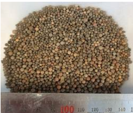
(a) 확장된 셰일(ES) (b) 소결점-플라이 애쉬(SCF) [사진 9] 이 연구에 사용되는 인공 경량 골재
