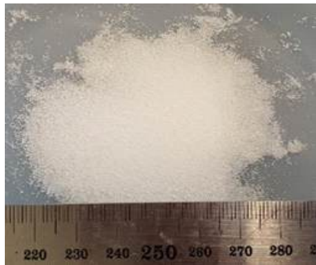
(b) 0.45mm 입자의 폴리머파우더(P1) (c) 0.28mm 입자의 폴리머파우더(P2) [사진 8] 연구에 사용되는 마이크로 플라스틱 골재
