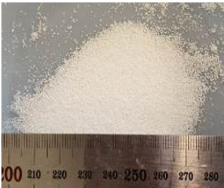
(b) 0.45mm 입자의 폴리머파우더(P1) (c) 0.28mm 입자의 폴리머파우더(P2) [사진 8] 연구에 사용되는 마이크로 플라스틱 골재
