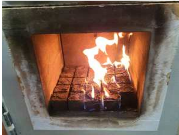
[사진 14] 400 °C에 노출된 미세 플라스틱을 함유한 UHPC 시편
