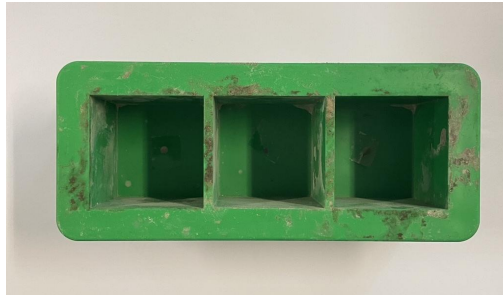
[그림 3-2] 압축강도 측정에 사용된 몰드
