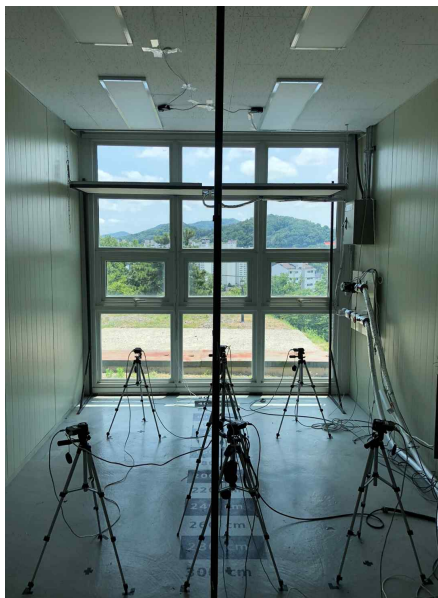
(b) 실내중앙 수직높이별 열전대 설치 모습
