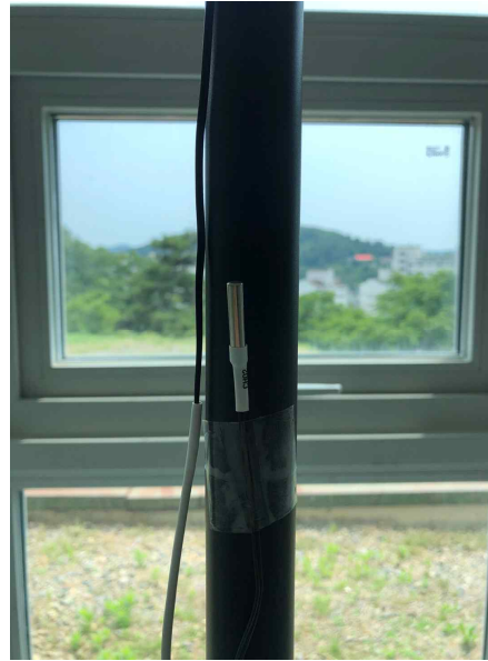
(a) 실내 외주부 수직높이별 열전대 설치 모습
