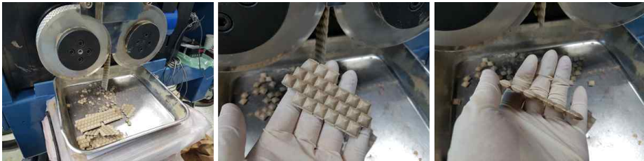
그림 26. Roll compactor를 이용한 펠릿 제조 모습
