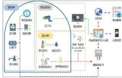
(b) 스마트팜 환경 유지용 온습도 측정 센서 구조
