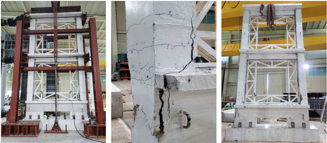
[그림 4.25] 실험체 TR-1 형상 및 최종파괴 형상
