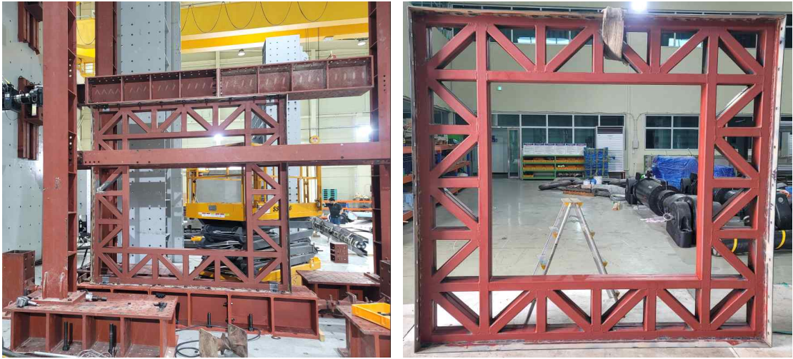
[그림 3.19] 실험체 Case 2_Plate 형상
