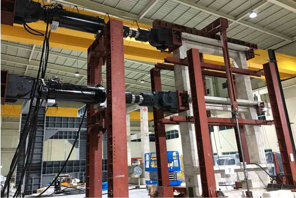
[그림 4.13] 2층 다중 각형 강재 유니트 보강골조 실험 전경
