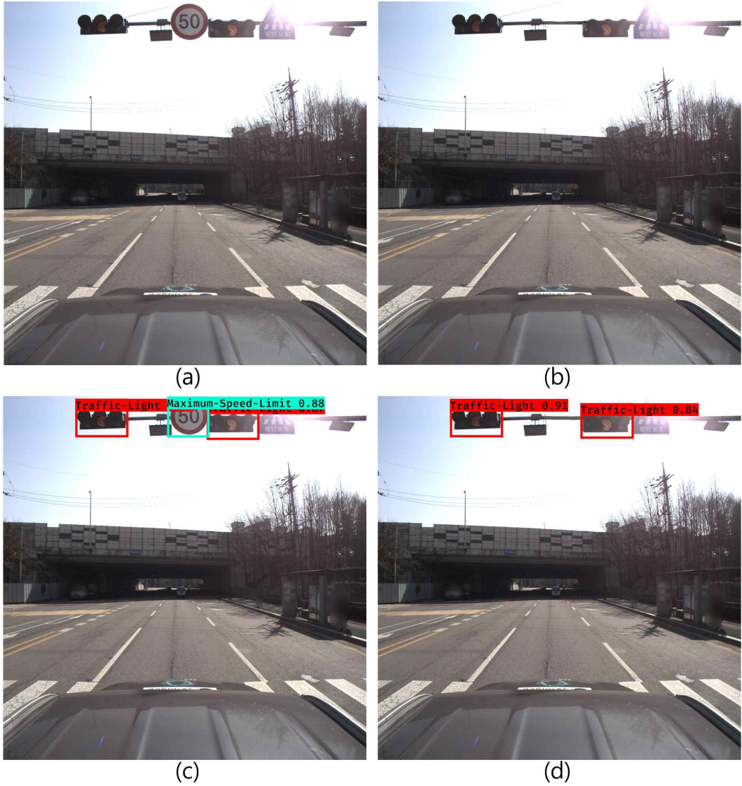
그림 4.15 제거된 도로시설물 객체 검출 예시1 (a) 원본이미지, (b) 객체제거 이미지, (c)원본이미지 객체검출결과, (d) 객체제거 이미지 객체검출결과
