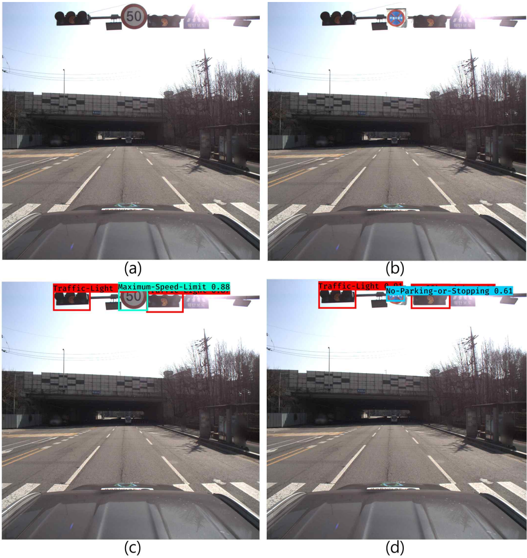
그림 4.17. 변경된 도로시설물 객체 검출 예시1 (a) 원본이미지, (b) 객체변경 이미지, (c)원본이미지 객체검출결과, (d) 객체변경 이미지 객체검출결과
